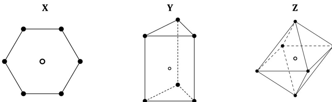
Dabei stehen die leeren Kreise für das zentrale Metallatom M und die gefüllten Kreise für die Positionen der Liganden. Die Struktur **X** ist hexagonal planar, **Y** ist trigonal prismatisch und **Z** oktaedrisch.
